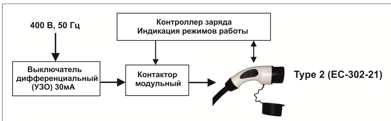
Рисунок 6 – Структурная схема станции EC-302-21
