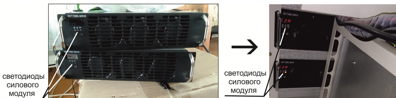
Рисунок 9 – Светодиоды силовых модулей
